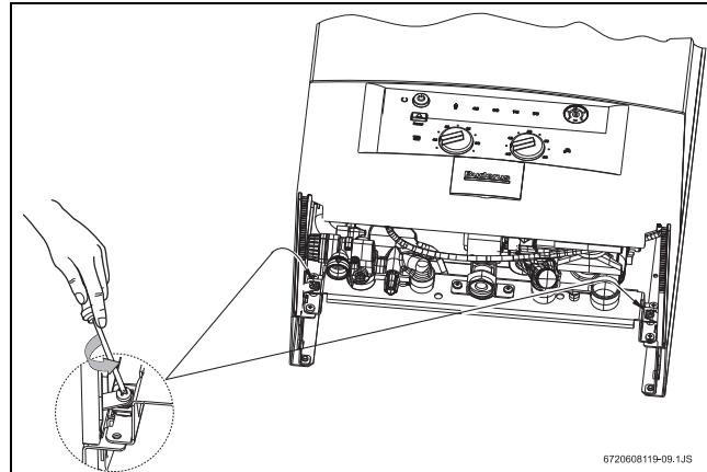
Рис. 7 Расположение винтов
