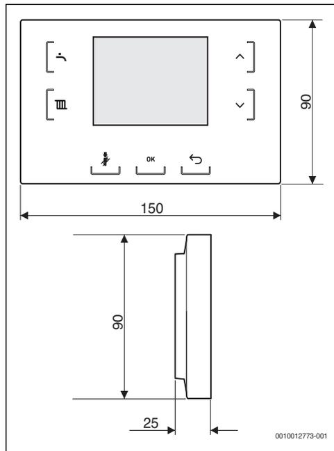
Рис. 1 Размеры, мм
