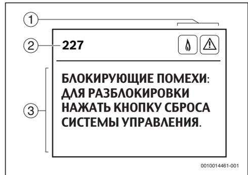
Рис. 7 Индикация неисправности
